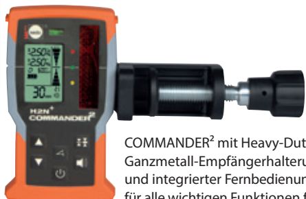
Auto-Align-Funktion (HVA und HVA2N): Auf Knopfdruck richtet sich die Laserebene automatisch auf den COMMANDER 2 -Empfänger aus. Optimal für den Schnurgerüsteinsatz oder beim Fassadenbau bei Distanzen bis zu 50 Metern.
