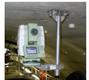
14-TK2: Überkopf-Montage im Firstbereich des Tunnels
