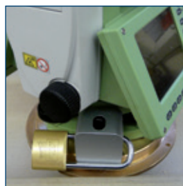
Bügelschloss einführen und verriegeln.
