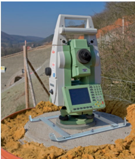
Montagerahmen von 14-WSH-P auf einem Betonpfeiler montiert.
