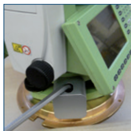
Tachylock-Diebstahlsicherung mit Inbusschlüssel festziehen.
