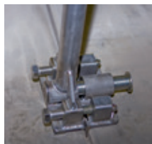
14-TK2: Detail Klemmechanismus
