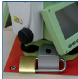
Bügelschloss einführen und verriegeln.
