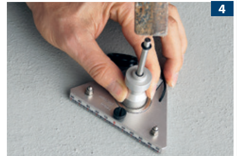
Markieren des abgesteckten Punktes mit der Basis A
