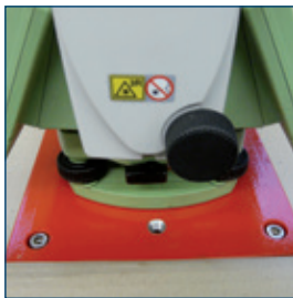
Instrument in Dreifuß einstecken und Verschluss verriegeln.
