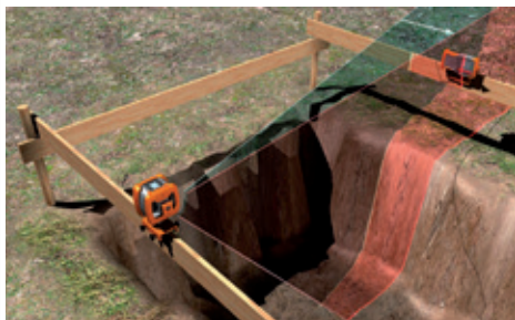
Auto-Align-Funktion (HVA und HVA2N): Auf Knopfdruck richtet sich die Laserebene automatisch auf den COMMANDER 2 -Empfänger aus. Optimal für den Schnurgerüsteinsatz oder beim Fassadenbau bei Distanzen bis zu 50 Metern.
