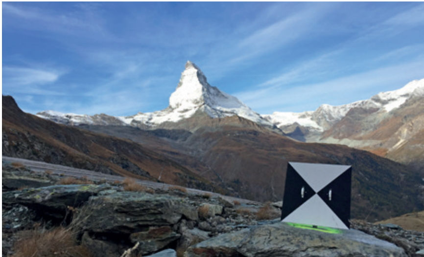
Zielzeichen 46-LZ200-1 im Einsatz bei einem Kunden (Bildnachweis Terradata AG)
