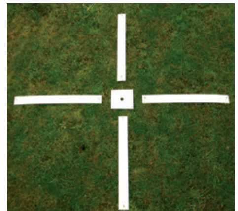
Typische Anordnung von Luftbildstreifen mit Luftbildplatte. Alle Artikel sind mit den Befestigungsnadeln LBN300 im Erdreich verankert.
