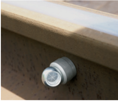
Kugelprismen-System bestehend aus einer magnetischen Kugel-Basis und dem Kugelprisma im Einsatz bei einer Gleisüberwachung.
