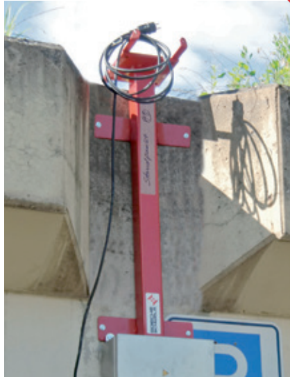
Sonderanfertigungen von mobilem Messpfeiler und Fassadenkonsole.
