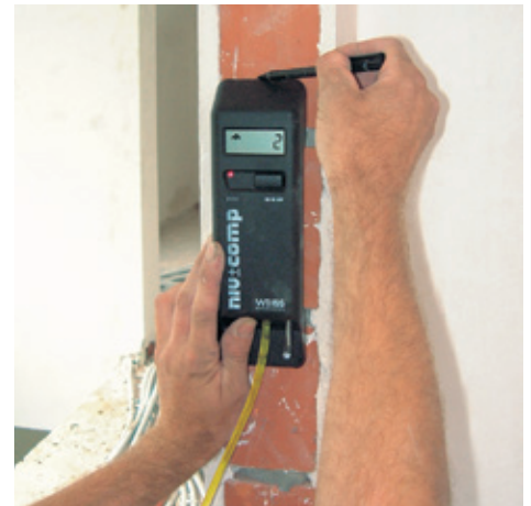
Zum Nivellieren von Boden- und Deckenpunkten eignet sich der optionale 5-teilige Tast-Stangensatz.
