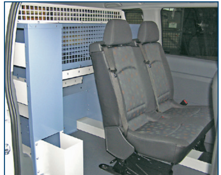
Mercedes-Benz Vito mit Heckeinrichtung classic. Hier wurde ein zusätzliches Fluchtstab-Fach eingebaut.
