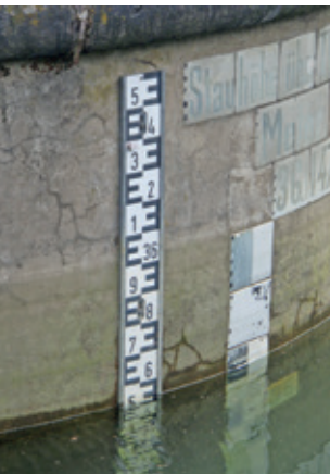
Senkrechtpegellatte an einem Talsperren-Bauwerk (Kundenfoto)
