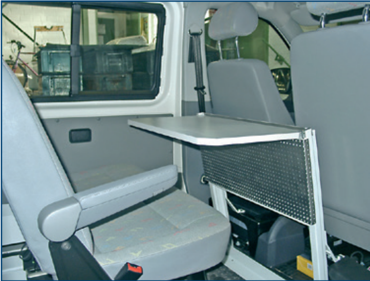
Klapptisch im VW-Bus T5/T6. Der Tisch wird im Bereich der Sitzkonsolen befestigt. Die Montage muss bei uns oder einem unserer Partnerbetriebe erfolgen.
